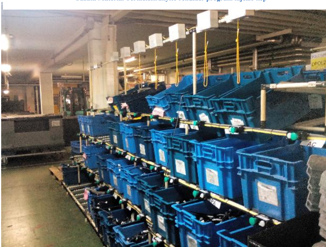
Polrendszer felszerelve ASI vezérlésű nyomógombos és húzókapcsolós lámpákkal
