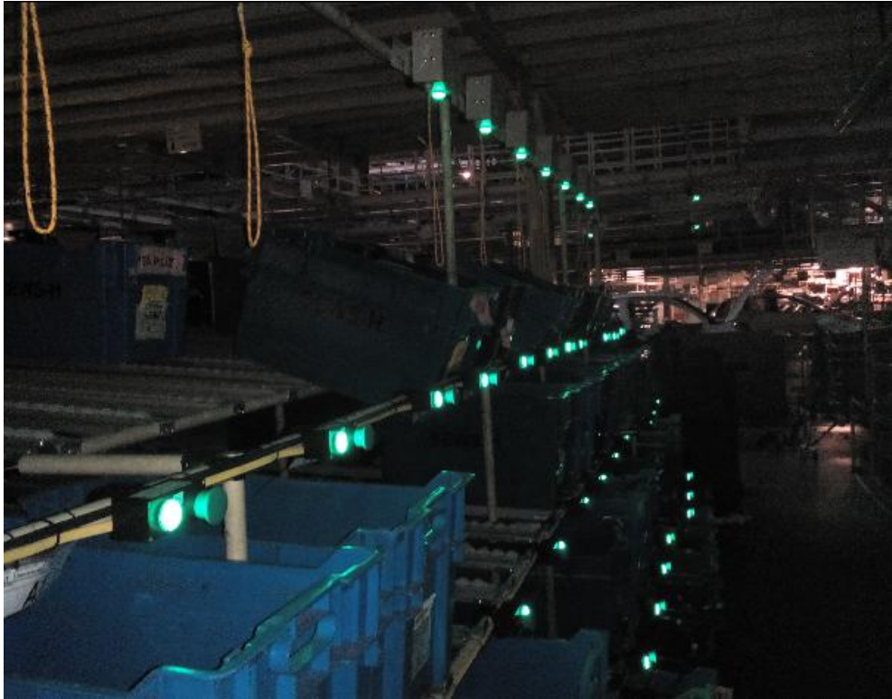
Polrendszer felszerelve ASi vezérlésű nyomógombos és húzókapcsolós lámpákkal
